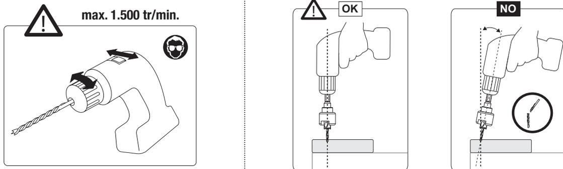
2. Avant son utilisation, s'assurer que la butée et le foret soient correctement ajustés pour la profondeur de fraisage et de perçage désirée. En cas de rotation difficile de la butée, une goutte de lubrifiant peut être nécessaire.
