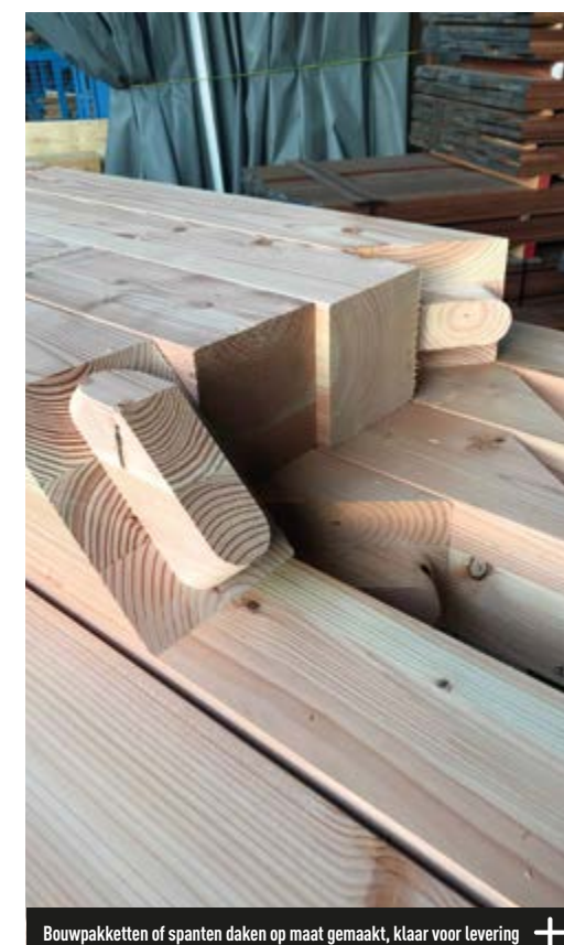
+ Bouwpakketten of spanten daken op maat gemaakt, klaar voor levering
