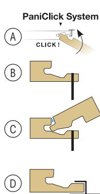
(A) (B) De lange zijden van de panelen beschikken over een gepatenteerd kliksysteem. De panelen worden bevestigd met nietjes, met onze Plano-clips 1513 of met een montagelijm.
