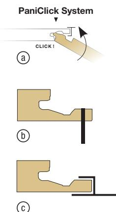
De lange zijden van de panelen beschikken over een gepatenteerd kliksysteem. (a) De panelen worden bevestigd met nietjes of met onze Plano-clips 1513. (b-c) **Let wel:** voor ruimtes langer of breder dan 7m wordt het gebruik van clips sterk aangeraden. De clips kan men nieten, alsook vijzen waardoor de panelen bevestigd kunnen worden op een metalen kader.
