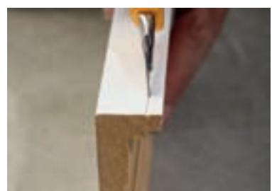
Met behulp van een scherp mes kan je de hoogte en dikte aanpassen. Snij in de uitsparing die voorzien is.
