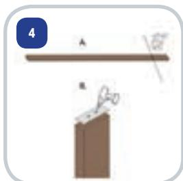
4. Kort het boven- en onderprofiel af met een cirkelzaag op de juiste lengte.
