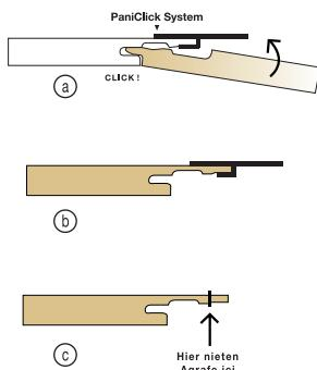
De lange zijden van de panelen beschikken over een gepatenteerd kliksysteem. (a) De panelen worden bevestigd met nietjes of met onze clips 1543. (b-c) **Let wel:** voor ruimtes langer of breder dan 7m wordt het gebruik van clips sterk aangeraden. De clips kan men nieten, alsook vijzen waardoor de panelen bevestigd kunnen worden op een metalen kader. Een montagekit is niet nodig.
