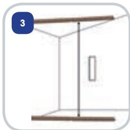
3. Meet heel nauwkeurig de afstand op tussen het boven- en onderprofiel.
