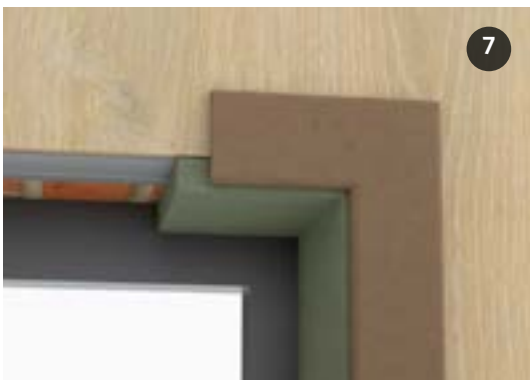
Finition porte avec MDF et moulure de porte.
