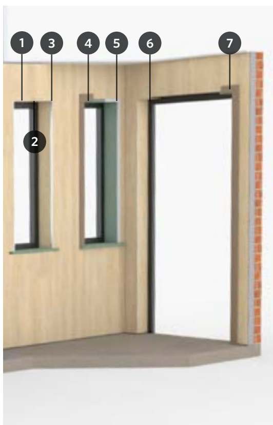
Finition fenêtre avec profilé en L en aluminium.
