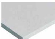
Gipsvezelplaten bestaan uit een homogeen mengsel gips en papiervezels. Deze worden op een computergestuurde productiestraat na toevoeging van water - zonder andere bindmiddelen - onder hoge druk tot stabiele en reukneutrale platen geperst, gedroogd en op maat gesneden.
