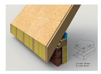
Les panneaux sont toujours posés en quinconce. Le côté court des panneaux repose toujours sur une poutre (minimum 18 mm).
